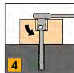
4 Надеть шестигранную гайку и затянуть
